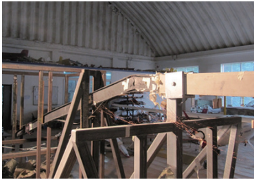
图17 翼梁静力破坏性试验
