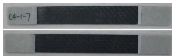
图4 材料的拉伸试验件 Fig.4 Tensile test piece of material
